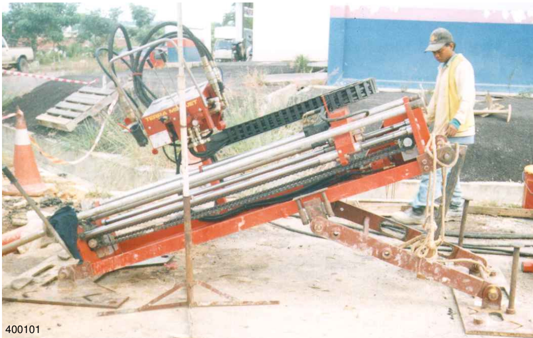
Bild links: Die Grubenlafette TERRA MINI-JET/LV mit Zubehör zum Oberflächenstart.
