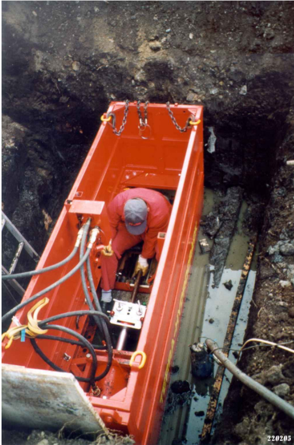
Bild links: Während der schnellen und einfachen Gestängemontage kann der Bedienungsmann im komfortablem Arbeitssitz sitzen.
