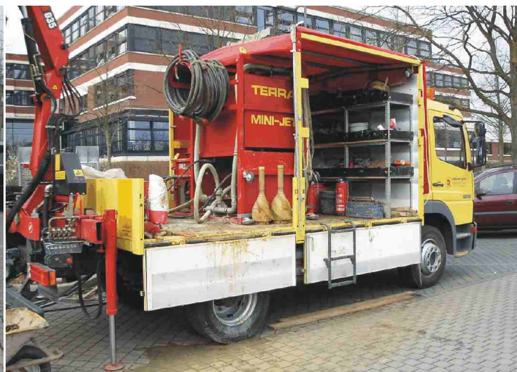
Eigens für den TERRA MINI-JET hat die Fa. Gerhard Rode Rohrleitungsbau GmbH & Co. diesen LKW mit Heckkran anfertigen lassen.
