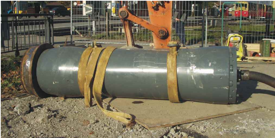
Der TERRA-HAMMER TR 565 mit montiertem Rammring.
