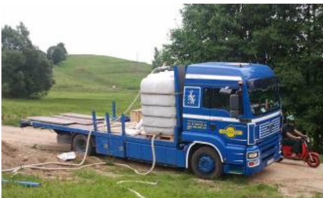
Dieser LKW der Firma Raba transportiert die komplette HDD-Bohranlage TERRA-JET 5415 S mit Zubehör.
