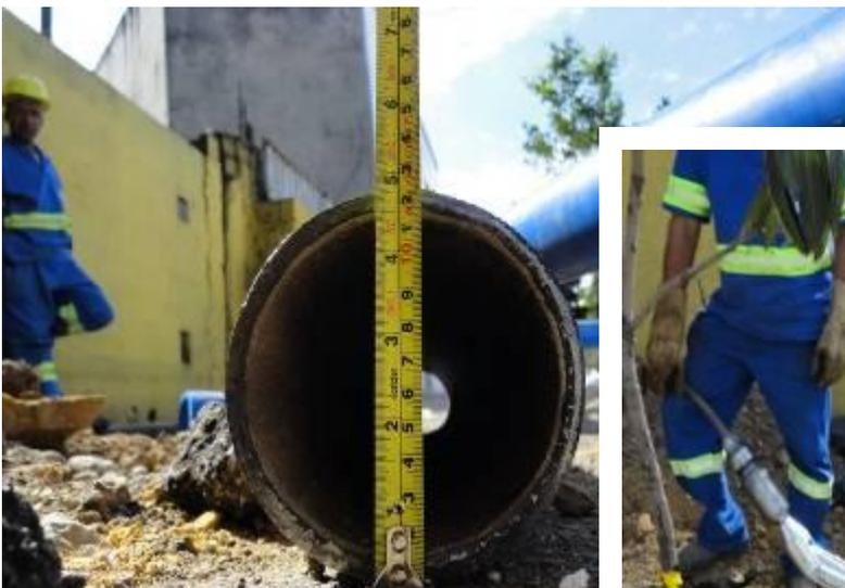
Dieses duktile Gussrohr mit DA 125 mm und einer Wandstärke von 8 mm soll vom X 400 geschnitten werden.
