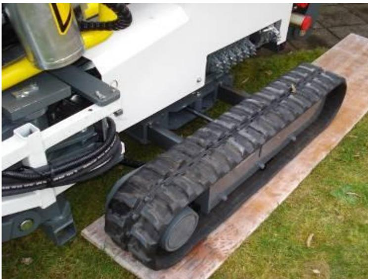
Das Gummiraupenfahrwerk kann in der Breite hydraulisch verstellt werden.
