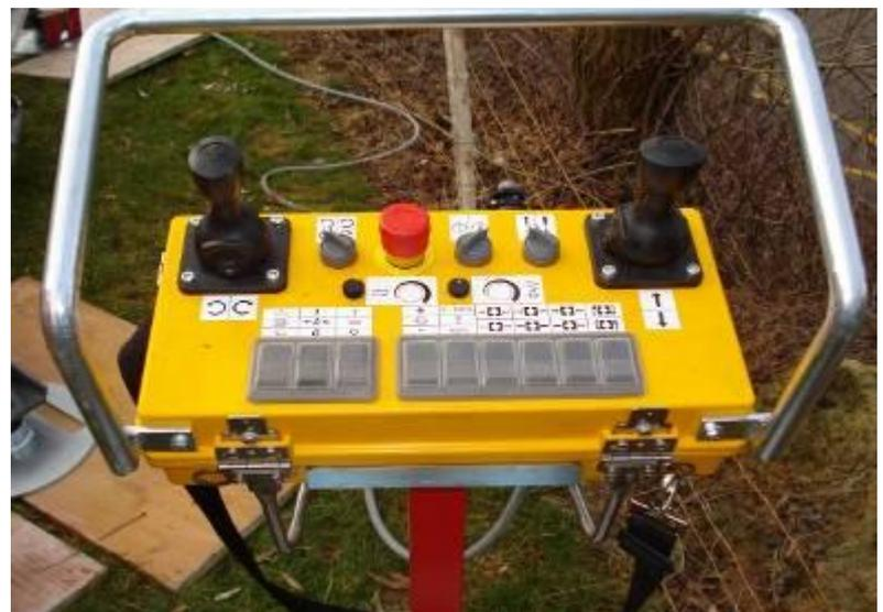
Mit der Bedieneinheit wird die komplette Bohranlage gesteuert. Im Bild links ist die dreifach Klemm- und Losbrecheinheit zu sehen. Die zwei oberen Klemmen schwenken zur besseren Zugänglichkeit nach aussen weg.
