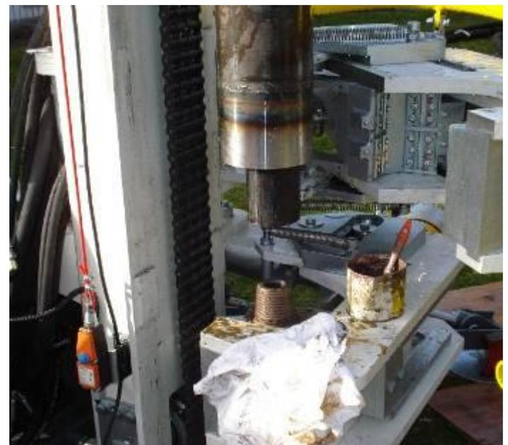
Innenbohrgestänge und Futterrohr werden verschraubt.
