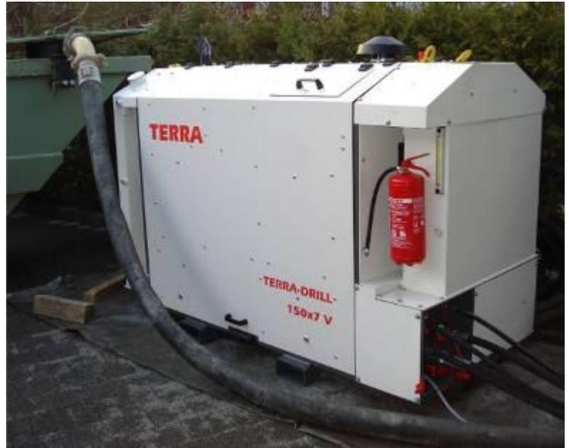
Das Hydraulikantriebsaggregat, welches die Bohranlage antreibt.
