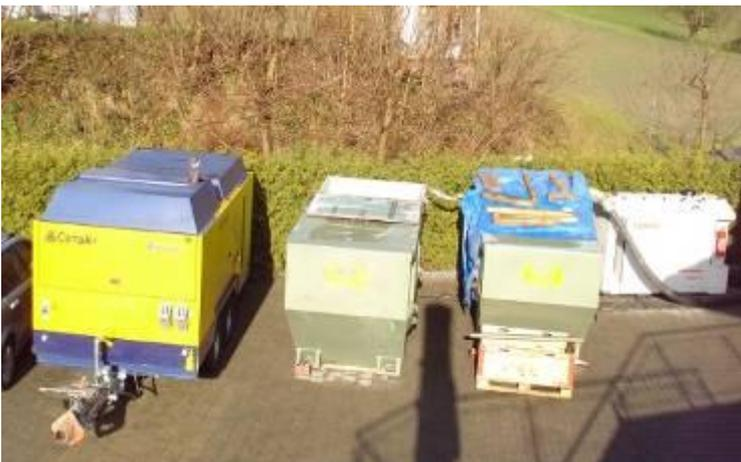
Der Druckluftkompressor, die beiden Absetzmulden für den Bohrschlamm sowie das Antriebsaggregat für den TERRA-DRILL 150x7 V stehen ausserhalb des Bohrplatzes.
