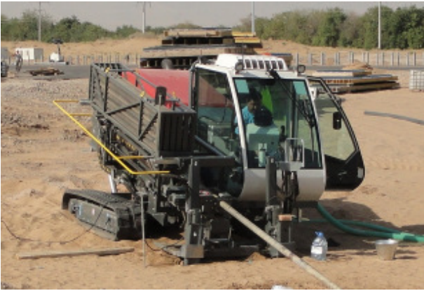
Der TERRA-JET 8522 S während der Bohrarbeiten. Die Komfort-Fahrerkabine wird mit einer leistungsstarken Klimaanlage gekühlt (Kühlleistung über 6 kW).
