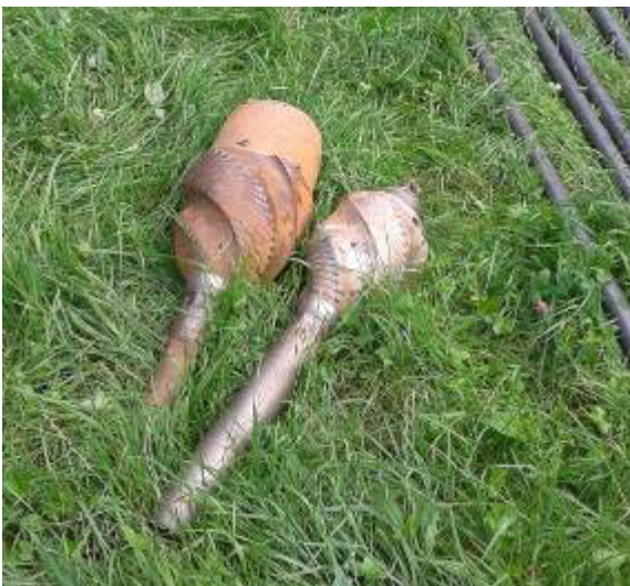
Die 49 m lange Pilotbohrung wurde mit diesen beiden Aufweitköpfe auf \varnothing 215 mm zwischen-aufgeweitet, anschliessend auf \varnothing 360 mm.
