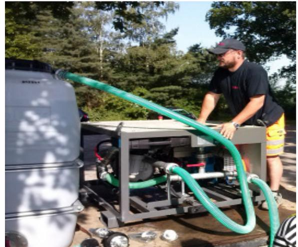
Die Misch- und Pumpstation kann ohne grossen Aufwand von der Ladefläche des Transportfahrzeuges betrieben werden.
