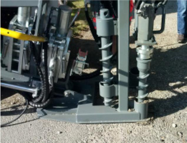
Die Verankerung erfolgt hydraulisch mit Erdankern, die selbst durch Asphalt bohren können. Somit ist der TERRA-JET 1804 S immer optimal verankert.
