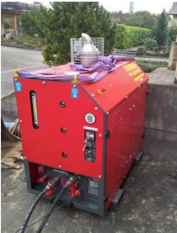
Die unter einem Privatgrundstück verlaufende Frischwasserleitung aus Grauguss erlitt bereits einmal einen Rohrbruch. Dieser Rohrbruch wurde repariert, indem ein Stück duktiles Gussrohr sowie eine duktile Schleife eingebaut wurde. Nun erfolgte der Ersatz dieser Wasserleitung mittels Berstlining-Verfahren. Zum Einsatz kam der Seilberster TERRA-EXTRACTOR X 400 mit einer maximalen Zugkraft von 40 Tonnen. Um diese duktilen Reparaturstücke zu schneiden, wurde ein Rollenmesser eingesetzt.
