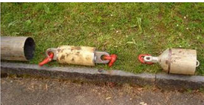
Die Zugkraftmesseinheit wird zwischen Aufweitkonus und Spreizdorn montiert. Die darüberliegende Schutzhülse schützt vor Beschädigung der Messeinheit durch Altrohrsherben.
