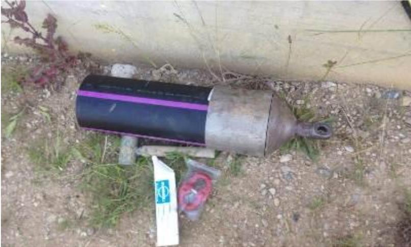
Mittels Spreizdorn wird das erste Kurzrohrmodul gespannt. Alle weiteren Kurzrohre werden anschliessend direkt im Schacht angeschraubt.
