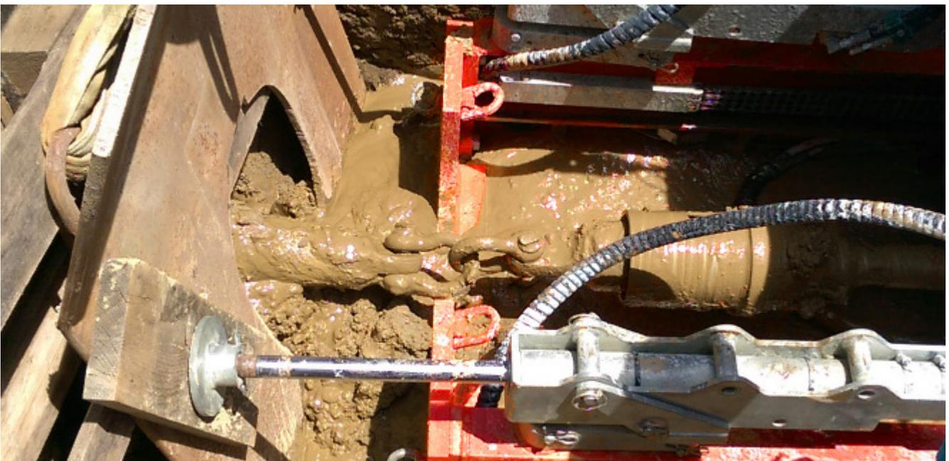
Bild 5: Die HDD-Grubenbohranlage TERRA-JET TJ 3008 ES ist so konzipiert, dass nach erfolgtem Rohreinzug das Räumwerkzeug und der Rohrziehkopf in die Maschine hineingezogen werden kann. Dies ermöglicht die Erstellung einer minimalen Grubengröße und gleichzeitiges Sicherstellen, dass das Rohr genügend weit aus dem Bohrkanal gezogen werden kann. Weiter gewährleistet es eine einfachere Demontage der Werkzeuge und Ziehköpfe.
