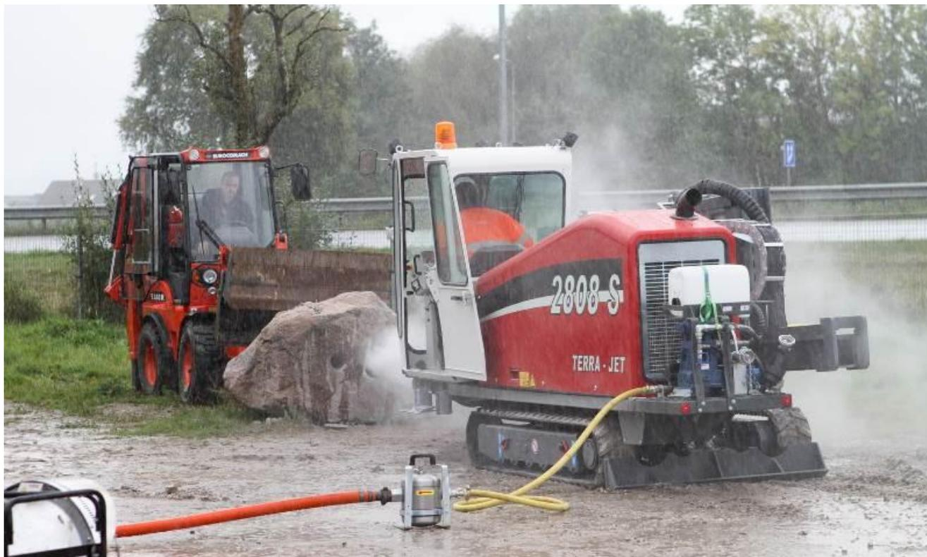
Bild 4: In nur 13 Minuten wurde dieser massive Granitblock durchbohrt.
