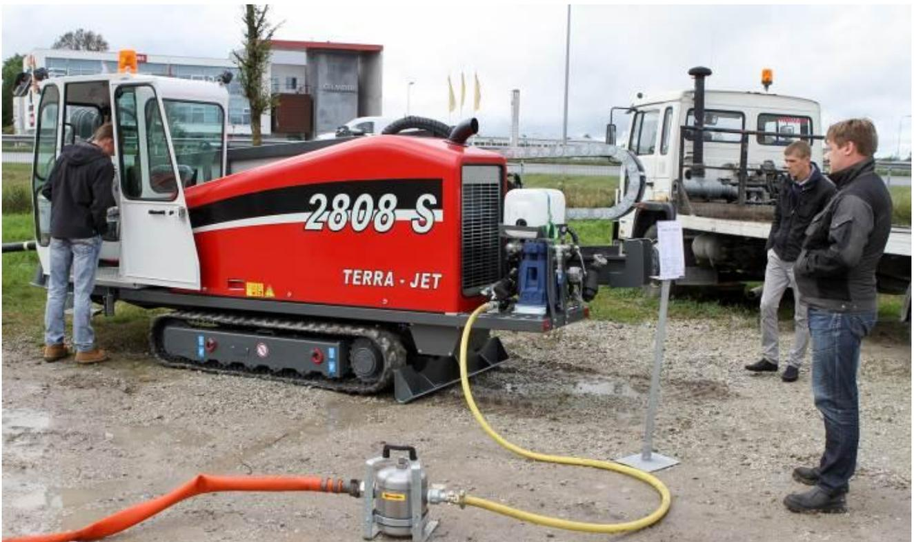
Bild 4: Der TERRA-JET TJ 2808 S kann umgerüstet werden um einen Druckluft-Hammer zu betreiben.
