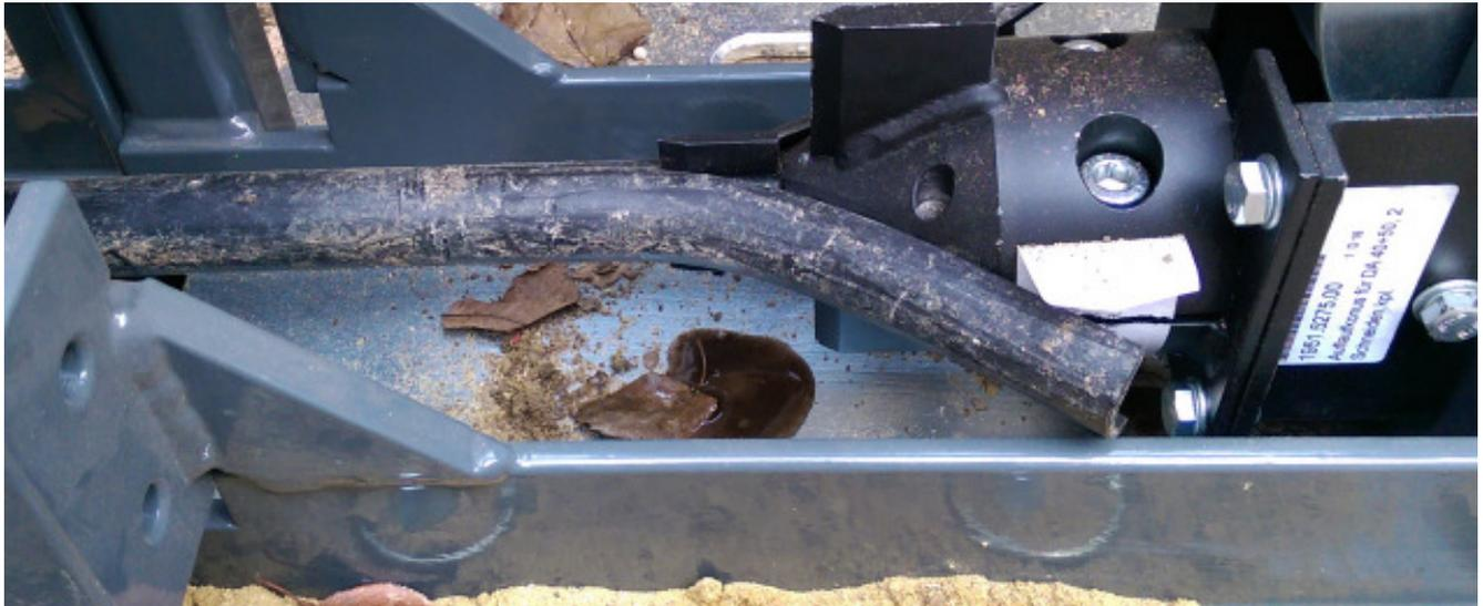
Bild 5: Da Altröhre beim Berstlining am Ende des Schneidevorgangs die Tendenz haben, aus dem Erdreich gezogen zu werden, ist maschinenseitig auch ein Schneidmesser angebracht. Dieses verhindert einerseits das Zusammenstauchen des Altröhres in Form einer Ziehharmonika und ermöglicht andererseits durch das Schneiden eine einfache Entnahme und Entsorgung.
