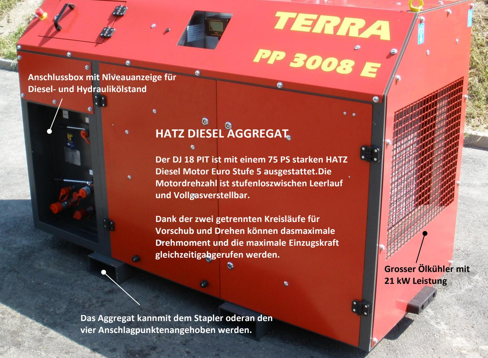
Anschlussbox mit Niveauanzeige für Diesel- und Hydraulikölstand
