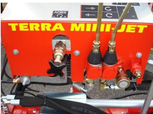
Am linken Rändelrad wird der ADBS-Druck eingestellt. Der rechte Bedienknopf regelt die Drehzahl.
