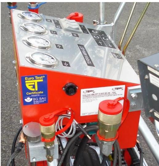
Hydraulik- und Stromanschluss
