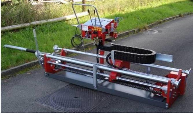
Die Grubenlafette TERRA MINI-JET MJLV 1600 mit Bohrkopf
