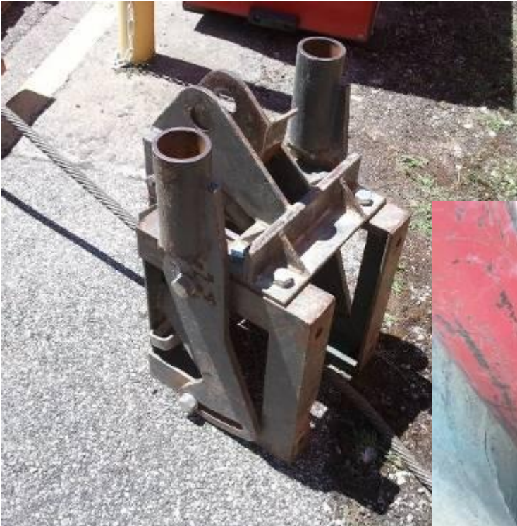
↑ Dieser Schachtrahmen passt durch den Schachtdeckel Ø 620 mm und kann am Boden von Schächten Ø 800 mm und 1'000 mm aufgestellt werden.
