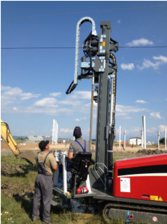
Bild 6: Der TERRA-JET TJ 2808 S beim Vertikalbohren.
