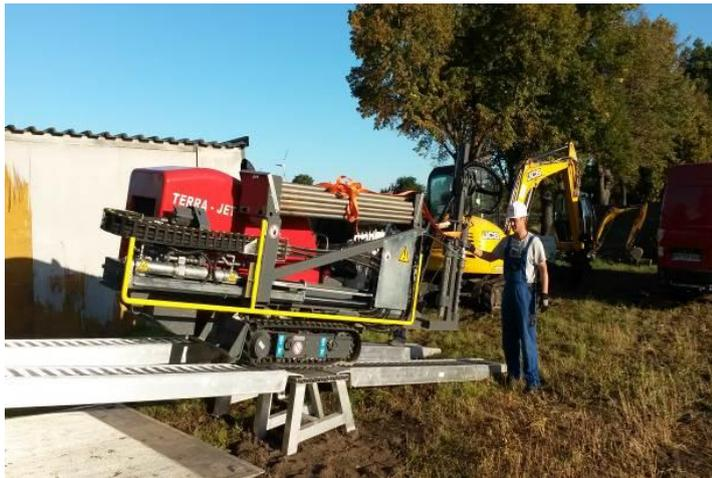
Bild 1: Die 4 Tonnen HDD-Spülbohranlage wird vom Laster mittels Rampe abgeladen.
