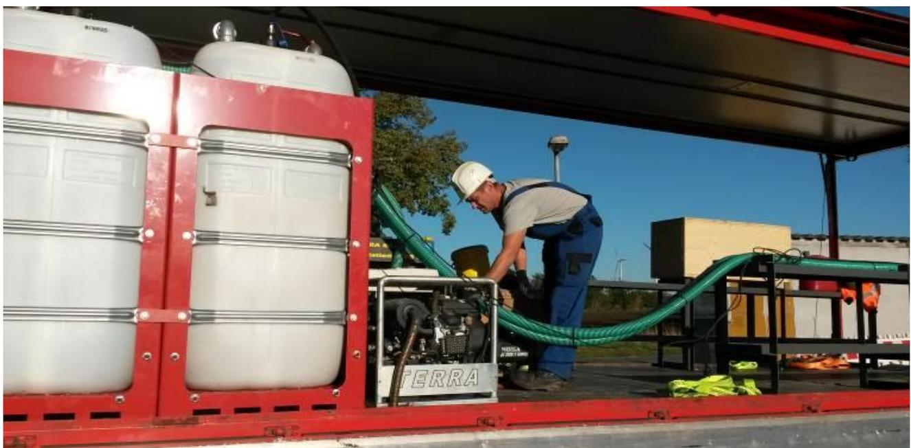
Bild 2: Die komplette Misch- und Pumpstation wurde bei der TERRA AG auf dem Laster montiert.
