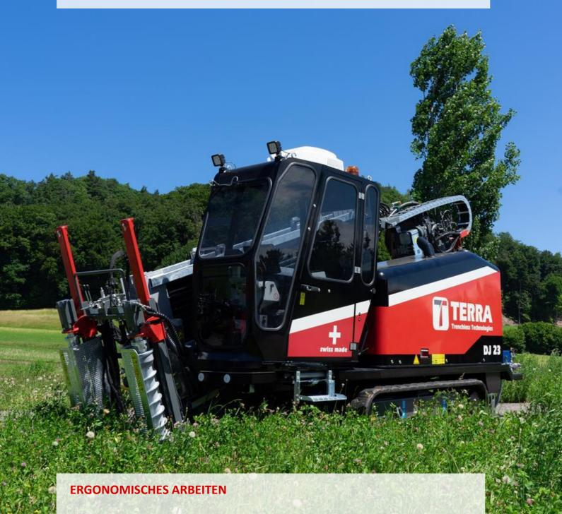
Mit dem reduzierten Geräuschpegel und dem reduzierten Dieselverbrauch ist die Maschine ideal für innerstädtische Gebiete. Die Maschine hat zudem einen kleinen CO<sub>2</sub>-Fussabdruck und eine schnelle Installationszeit.
